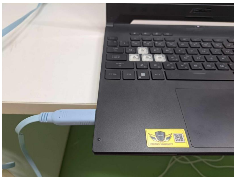
ภาพที่ 4.11 เชื่อมต่อสายสัญญาณ USB Serial Port กับพอร์ต USB ของคอมพิวเตอร์
