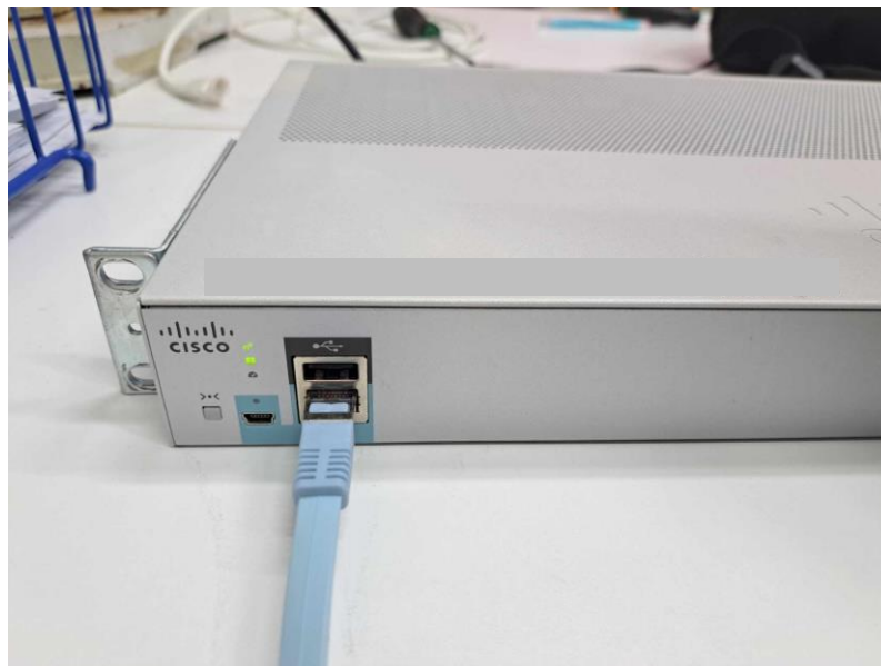
ภาพที่ 4.10 เชื่อมต่อสายสัญญาณ USB Serial Port กับพอร์ตการเชื่อมต่อ Control Port
